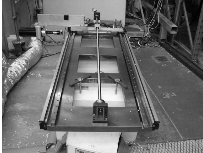
Abbildung 4.14: Ein Foto der optischen Bank. Zu erkennen ist die Grundplatte mit den beiden seitlich montierten Längenmeßsystem, sowie das Fernrohr in seiner Halterung.
